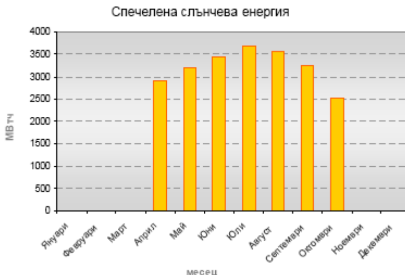
Фиг. 8: Разпределение на възможната за оползотворяване слънчева енергия по месеци при сезонна работа на инсталациите
